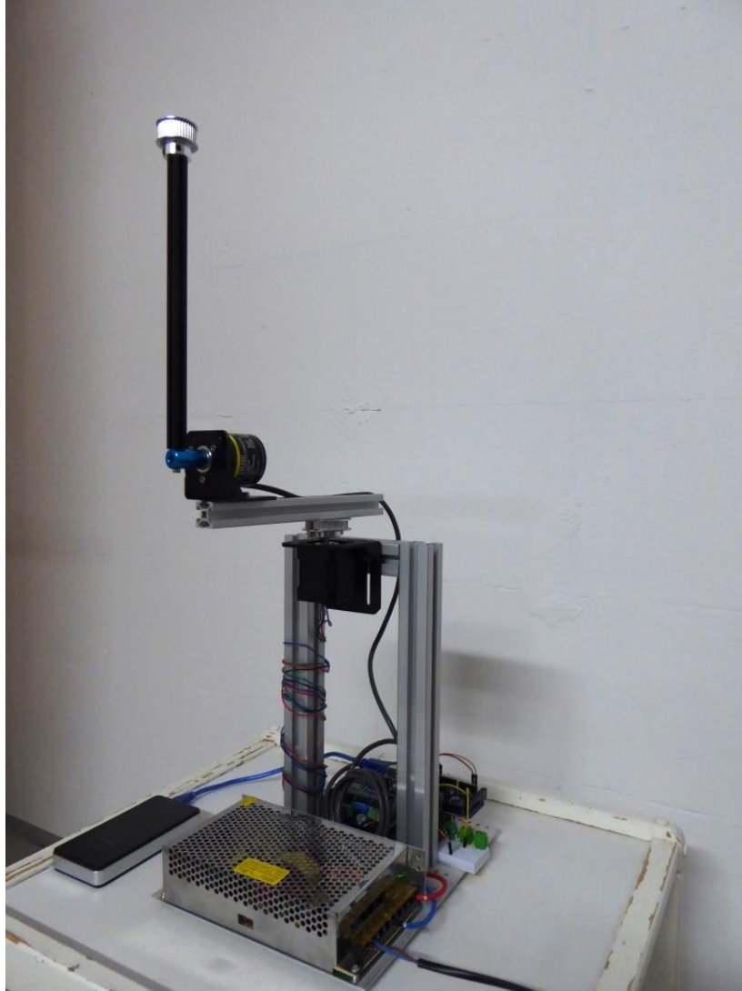
Labora Aufbau des rotierenden inversen Pendels
