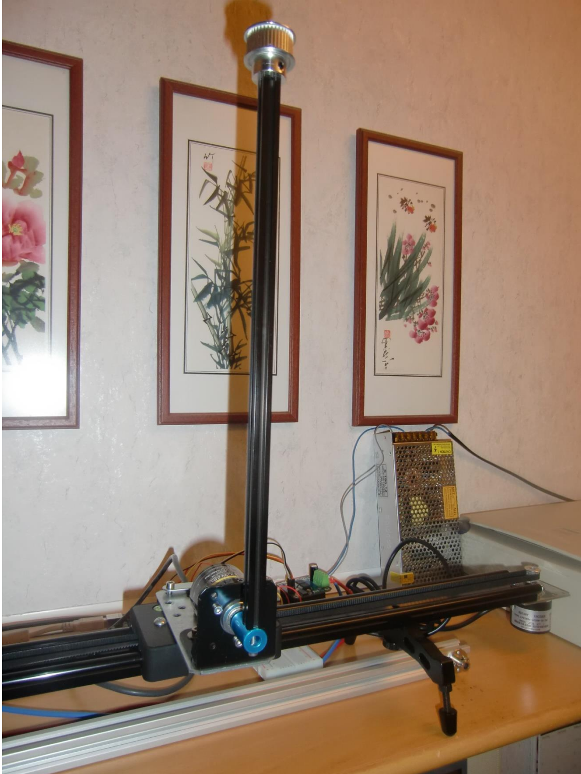
Bild2 : das inverse Pendel im Laboraufbau
