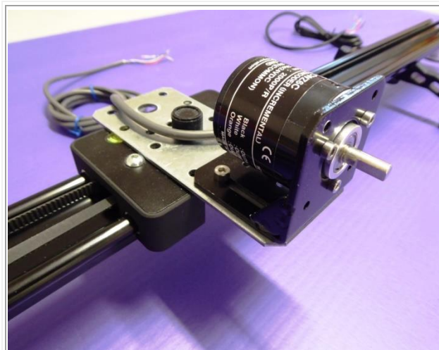
Befestigung des Winkelencoders auf dem Schlitten
