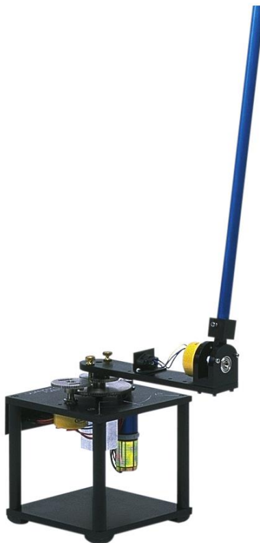
Bild 6: Aufbau eines rotierenden inversen Pendels
