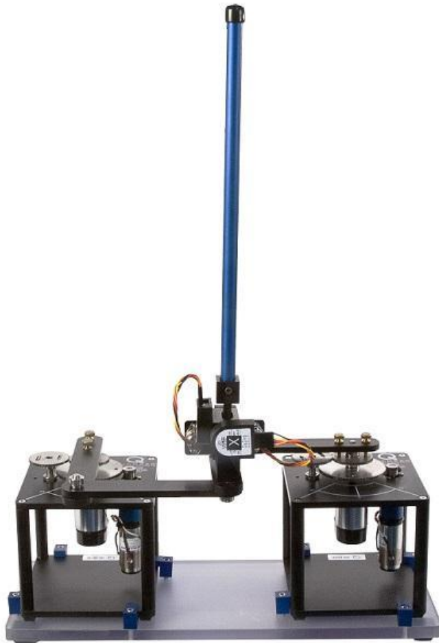
Bild 7: Aufbau eines sphärischen inversen Pendels
