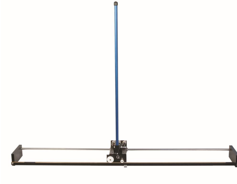
Bild 3: inverses Pendel mit Linearführung
